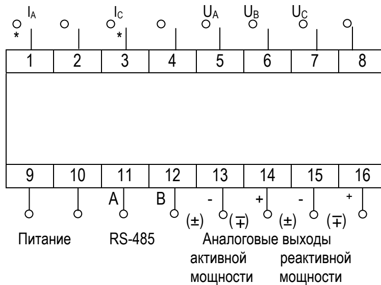
Рисунок А.2 – Схема электрическая подключения измерительных преобразователей, имеющих аналоговые выходы
