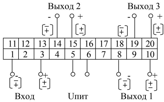
Рисунок А.2 - Схема электрическая подключений одноканальных измерительных преобразователей
