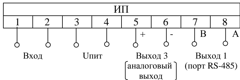
Рисунок Б.4 - Схема электрическая подключений ИП Е 854/5ЭС-ЦМ
