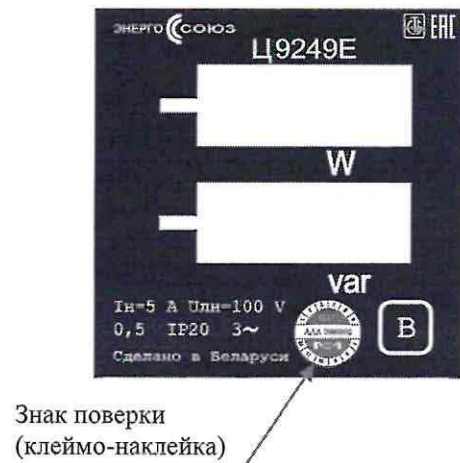
Рисунок 2.1 – Схема с указанием места для нанесения знака поверки на преобразователи Ц9249Е с двухстрочной индикацией
