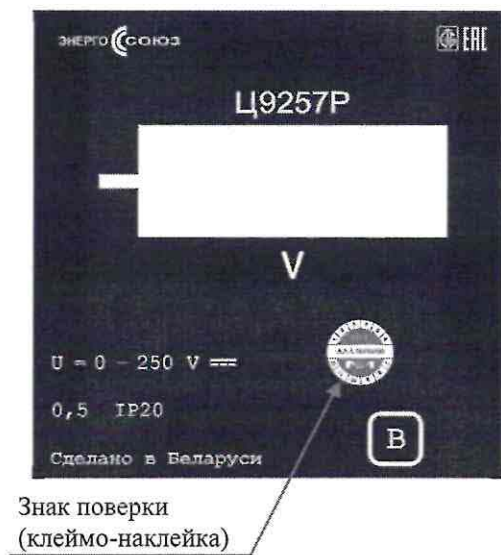
Рисунок 2.4 – Схема с указанием места для нанесения знака поверки на преобразователи Ц9254P, Ц9255P, Ц9256P, Ц9257P, Ц9258P, Ц9259P, Ц9260P с однострочной индикацией
