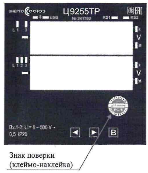
Рисунок 2.8 – Схема с указанием места для нанесения знака поверки на преобразователи Ц9254TP, Ц9255TP с двухстрочной многоцветной индикацией
