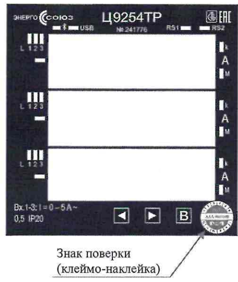
Рисунок 2.7 – Схема с указанием места для нанесения знака поверки на преобразователи Ц9254TP, Ц9255TP с трехстрочной многоцветной индикацией
