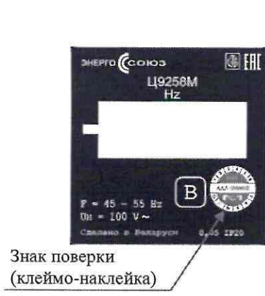
Рисунок 2.5 – Схема с указанием места для нанесения знака поверки на преобразователи Ц9254М, Ц9255М, Ц9256М, Ц9257М, Ц9258М с однострочной индикацией
