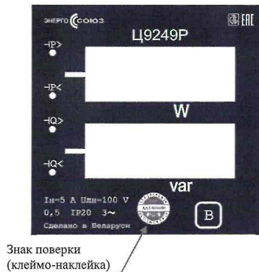
Рисунок 2.3 – Схема с указанием места для нанесения знака поверки на преобразователи Ц9249P с двухстрочной индикацией
