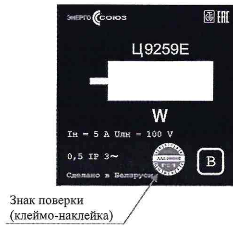
Рисунок 2.2 – Схема с указанием места для нанесения знака поверки на преобразователи Ц9254Е, Ц9255Е, Ц9256Е, Ц9257Е, Ц9258Е, Ц9259Е, Ц9260Е с однострочной индикацией
