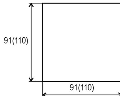
Примечание – Без скобок указаны размеры окна для крепления прибора конструктивного исполнения Е, в скобках – для крепления прибора конструктивного исполнения Р.
