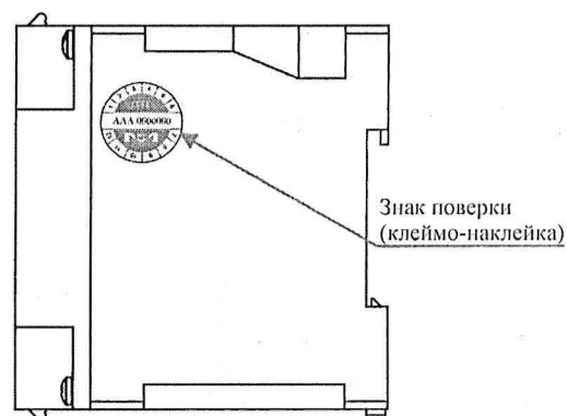
Рисунок 2.2 – Схема с указанием места для нанесения знака поверки на преобразователи в корпусах М16, М20, М24
