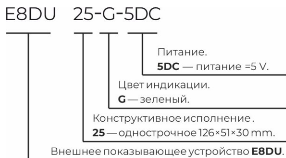
Рисунок 2 – Схема условного обозначения E8DU (поставляется в комплекте для ИП с портом для внешнего показывающего устройства)
