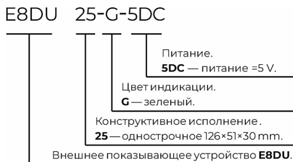
Рисунок 2 – Схема условного обозначения E8DU
