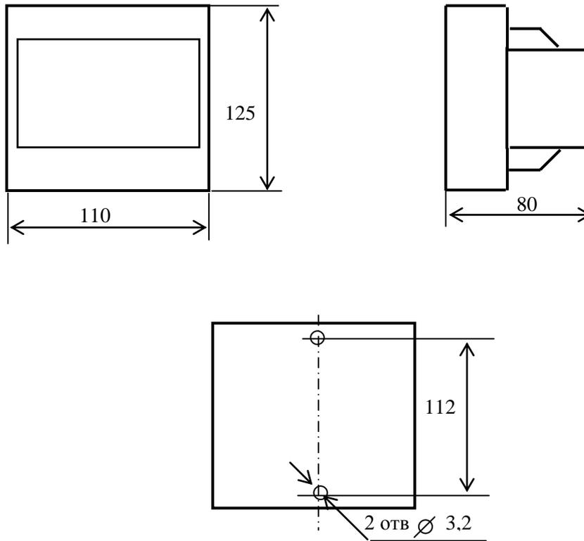
Рисунок А.1 – Габаритные и установочные размеры
